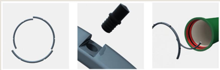
Фиксация сегментов в ходе монтажа происходит с помощью поддерживающих элементов, закрепляемых между собой в специальных отверстиях. Поверхности внутри раструба и стопорного кольца взаимодействуют таким образом, что при попытке обратного движения гладкого конца раструба сжимается стопорное кольцо. Это соединение применяется на трубах из ВЧШГ с диаметрами от Ду 300 до Ду 1200 мм.
